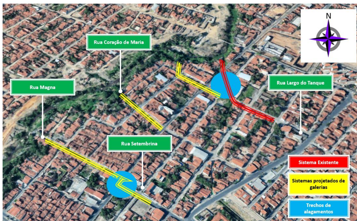
Figura 2 - Esquema do sistema projetado de drenagem.
