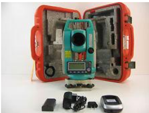
Foto 1- Modelo da estação total utilizada.
